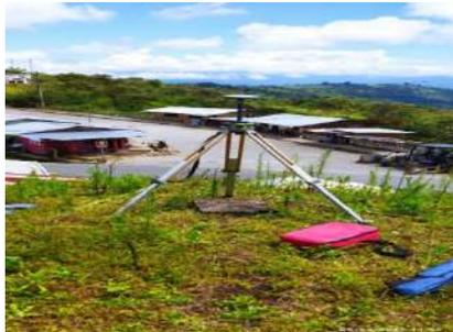
Toma de datos de campo, con colectora GPS Rover. Vía Gualéa.
