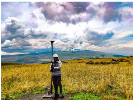
Levantamiento topográfico con el sistema RTK, Proyecto de Riego Toropugro, cantón Quito.
