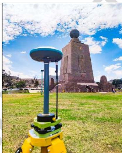
Levantamiento topográfico con GPS de precisión en modo RTK.
